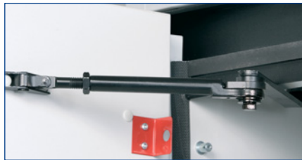
Brazo de fijación - las puertas se fijan a 0 grados por medio del cierre de bola (aunque no estén cerradas) y se pueden fijar a 90°.
